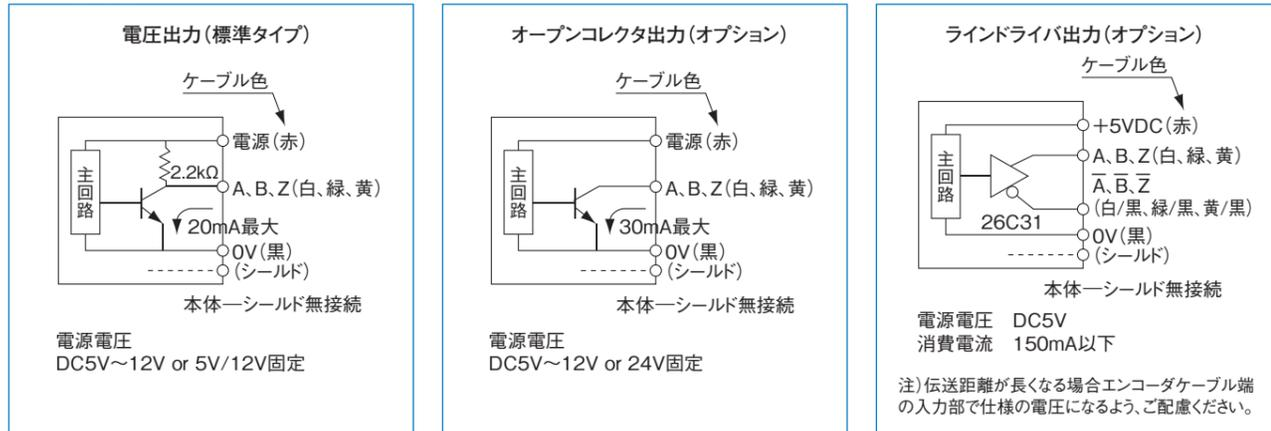
0VとFG(フレームグランド)の間にコンデンサ(0.1μF)が接続されています。
